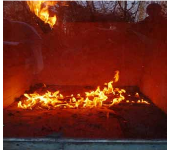
PANEL KISZERELÉSŰ HŐSZIGETELŐ MENNYEZETBURKOLAT GYÚJTÁSVEZÉLYESSÉGÉNEK VIZSGÁLATA (MSZ 14890:2014)
